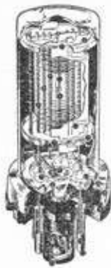
fig. 61 Amerikaanse stalen buis in doorsnee
