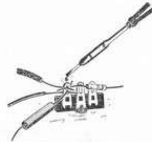
Een druppel soldeer moet aan de bout blijven hangen
