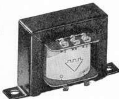
Een type uitgangstransformator zoals dat wordt gebruikt in kleine versterkers en radio-toestellen
