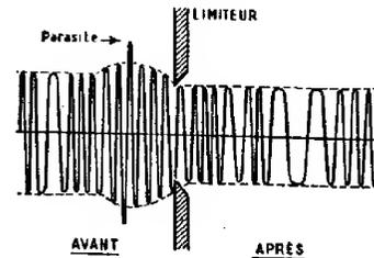
FIG. 128. — Croquis expliquant le mécanisme d'un écrêtage « bilatéral » d'une onde modulée en fréquence, mais présentant néanmoins des variations d'amplitude.
