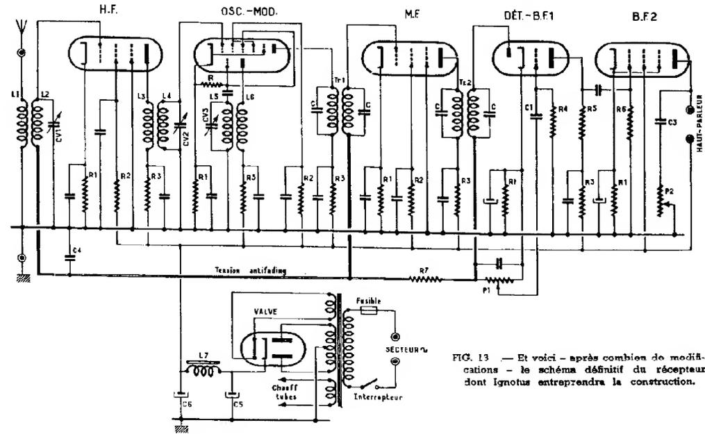
FIG. 13 — Et voici — après combien de modifications — le schéma définitif du récepteur dont Ignotez entreprendra la construction.
