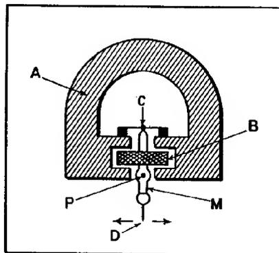
FIG. 131. — Composition d'un graveur de disques.
