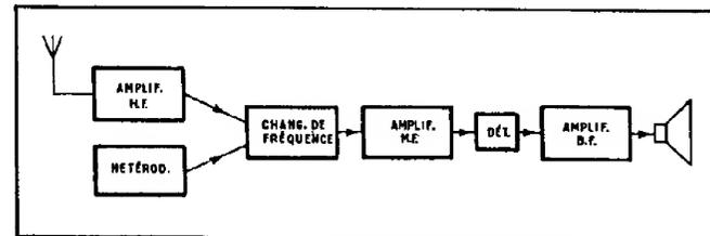
FIG. 92. — Composition schématisée d'un superhétérodyne.
