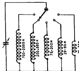
FIG. 78 et 79. — Méthode de commutation pour 3 gammes d'ondes.
