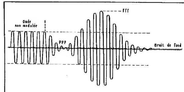
FIG. 120. — Lorsqu'une porteuse H.F. est modulée en amplitude, les limites de cette modulation sont constituées par le double de l'amplitude de l'onde non modulée pour le maximum, et par le bruit de fond pour le minimum.
