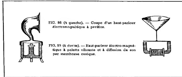
FIG. 98 (à gauche). — Coupe d'un haut-parleur électromagnétique à pavillon.
