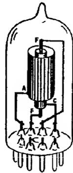
FIG. 26. — La diode : F, filament ; C, cathode ; A, anode.
