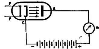
FIG. 26. — Le milliampèremètre mA permet de mesurer le courant qui va de la cathode C à l'anode A.
