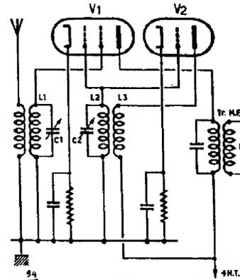
FIG. 94. — Changement de fréquence par modulaire bigrille  $V_1$  et oscillatrice triode  $V_2$ .
