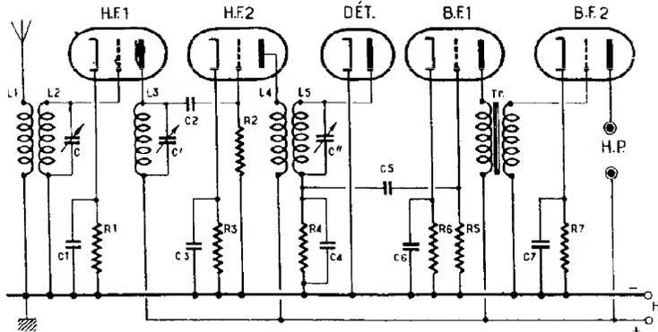
FIG. 64. — C'est Ignotus qui a tracé ce schéma !... Les résistances de polarisation sont désignées par  $R_1, R_2, R_3$  et  $R_4$ , et les condensateurs correspondants par  $C_1, C_2, C_3$  et  $C_4$ . —  $R_5$  et  $R_6$  sont les résistances de fuite.
