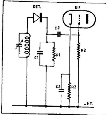
FIG. 60. — Simplifié d'une diode à semiconducteur à la place de la diode à vide de la fig. 69.
