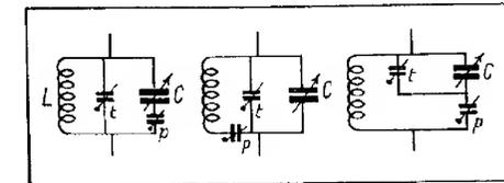
FIG. XVI. — Trois modes de connexion des trimmers t et des padding p dans le circuit d'accord de l'oscillateur en vue d'assurer le réglage unique.
