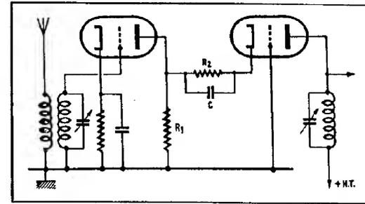
FIG. 124. — Ici on voit la structure théorique du montage dit cascade. A signaler que la résistance  $R_1$  n'est nullement nécessaire.
