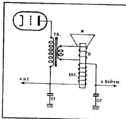
FIG. 102. — Le bobinage d'excitation servant d'impédance de filtre.
