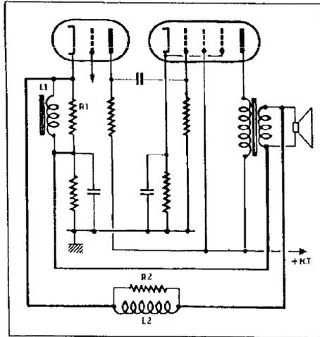
FIG. XXVIII. — Contre-réaction sur l'amplificateur B.F. avec correction de tonalité. La résistance  $R_1$  est de l'ordre de 10 à 20 ohms,  $R_2$  est de 500 ohms,  $L_1$  est de 25 millihenrys,  $L_2$  est de 18 millihenrys.
