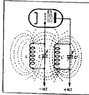
FIG. 69. — Couplages parasites par induction (champs magnétiques des bobinages en pointillés) et par capacité C<sub>1</sub> entre grille et plaque.
