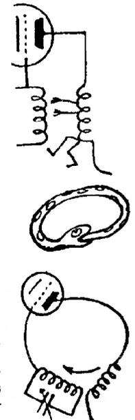
IG. — Ainsi, la réaction de  $L'$  sur  $L$ , si j'ai bien compris, renforce les oscillations dans  $L$ . Mais, dans ce cas, ces oscillations renforcées seront, à leur tour, amplifiées par la lampe et donneront lieu, dans la bobine de réaction  $L'$ , à un courant encore plus fort. Ce courant, par induction, renforcera encore davantage les oscillations dans  $L$  et ainsi de suite. L'amplification croîtra donc indéfiniment ?...
