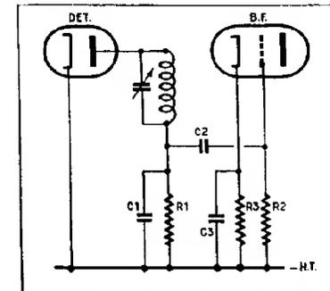
FIG. 59 (à droite). — Liaison entre diode et triode B. F. Les tensions développées dans C, R, sont transmises à travers C, à la grille B. F. avec sa résistance de fuite  $R_2$ . Quant à C, et  $R_1$ , ils assurent la polarisation de la lampe B. F.
