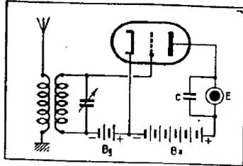
FIG. 42. — Schéma de la détection par courbure de la caractéristique de plaque.
