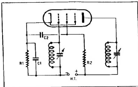
FIG. XIII. — Le potentiel de la grille-écran est fixé ici par la chute de tension dans R<sub>1</sub>. La composante variable est écoulée à travers C<sub>2</sub> vers la cathode.
