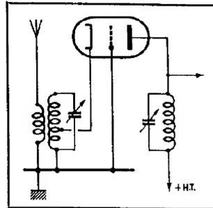
FIG. 123. — Voici comment se présente, dans sa forme classique, le montage d'une triode amplificatrice H.F. avec grille à la masse.
