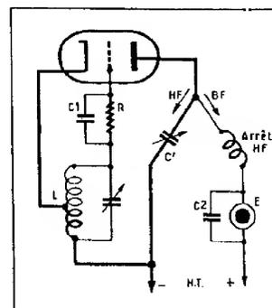
FIG. 68. — Montage dit « Hardley ». Le trajet de la haute fréquence est marqué en gros trait.
