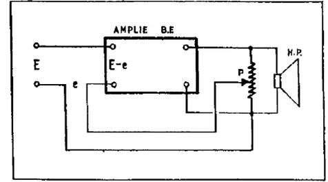
FIG. XXVI. — Schéma général de la contre-réaction. La portion nécessaire de la tension de sortie est prélevée à l'aide du potentiomètre P.
