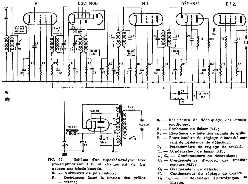
FIG. 97. — Schéma d'un superhétérodyne avec pré-amplificateur H.F. et changement de fréquence par triode-hexode.
