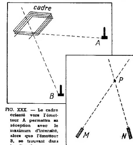
FIG. XXX. — Le cadre orienté vers l'émetteur A permettra sa réception avec le maximum d'intensité, alors que l'émetteur B, se trouvant dans la direction perpendiculaire, ne sera pas reçu.
