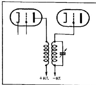
FIG. 52. — Liaison par transformateur H.F. à secondaire accordé.
