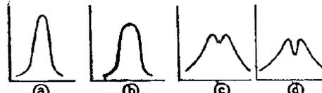
FIG. XXV. — Deux circuits accordés couplés donnent lieu à l'une des quatre courbes de résonance ci-dessus suivant que le couplage est lâche (a), moyen (b), serré (c) ou très serré (d).
