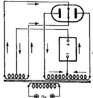
FIG. 88. — Schéma pratique du redresseur de la figure 83.
