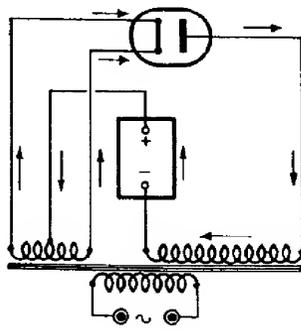
FIG. 87. — Schéma pratique du redresseur de la figure 81.
