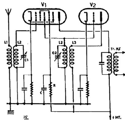
FIG. 95. — Une hexode s'acquies des fonctions de changeuse de fréquence bien mieux que l'antique bigrille.
