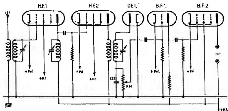
FIG. 76. — « Schéma-squelette » du récepteur à deux étages H.F.
