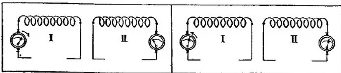
FIG. 8 a. — Lorsque le courant dans la bobine I augmente, il induit dans la bobine II un courant de sens contraire.
