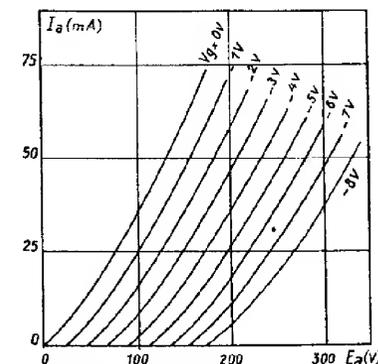
FIG. II. — Courbes montrant la variation du courant de plaque d'une triode en fonction des variations de la tension de plaque. Chaque courbe est relevée pour une tension de grille  $V_g$  (également appelée  $E_g$ ).
