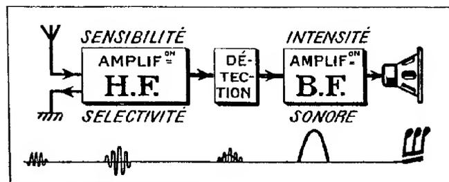
FIG. 44. — Schéma le plus... schématisé d'un récepteur.
