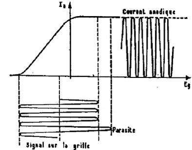
FIG. 129. — Une lampe peut écrêter par les coudes inférieur et supérieur de sa caractéristique.
