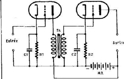
FIG. 51. — Amplificateur à deux lampes avec polarisation des grilles par les résistances R<sub>1</sub> et R<sub>2</sub>.
