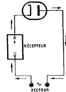
FIG. 80. — Schéma du redresseur le plus simple.
