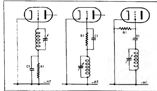
FIG. 62. — La soi-disant « détection par la grille ».
