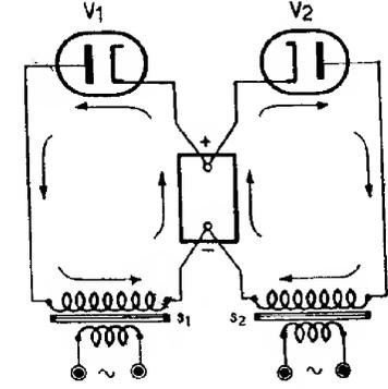
FIG. 84. — Les deux redresseurs de la figure 83 alimentent le même récepteur en redressant les deux alternances.
