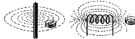
FIG. 6. — Champ magnétique d'un conducteur rectiligne et d'un bobinage.
