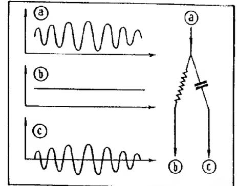
FIG. VII — Un courant anodique variable a peut être considéré comme la somme de deux composantes : une continue b et une alternative c. — A droite, montage de séparation des deux composantes.
