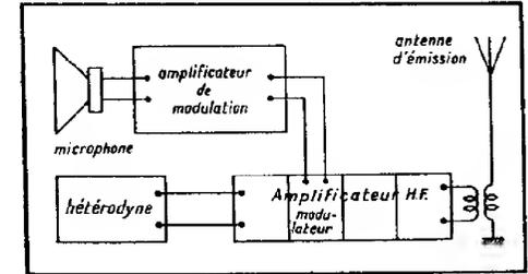
FIG. 5. — Composition d'un émetteur de radiophonie.
