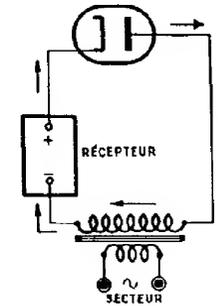
FIG. 81. — Redresseur avec transformateur élevant la tension.
