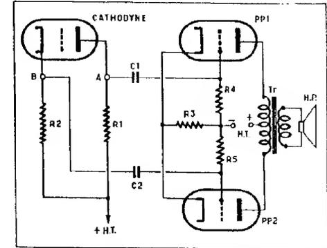
FIG. XI. — Dans le cathodyne, des tensions de phases opposées sont prélevées sur les résistances de charge placées dans l'anode (R<sub>1</sub>) et dans la cathode (R<sub>2</sub>) afin d'attaquer les deux tubes du push-pull.
