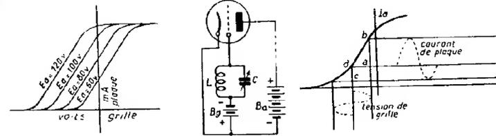
FIG. 32. — Famille de courbes dont chacune correspond à une tension  $E_a$  de plaque déterminée.
