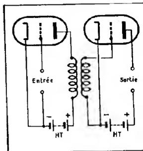
FIG. 47. — Couplage par transformateur de deux lampes amplificatrices.
