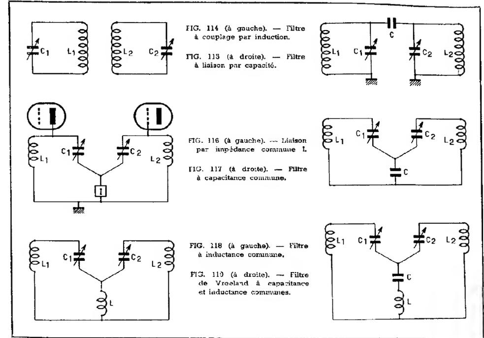
FIG. 114 (à gauche). — Filtre à couplage par induction.
