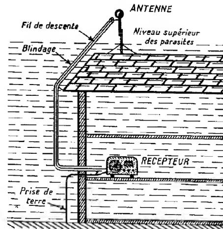
FIG. XXX. — Installation d'une antenne antiparasite.
