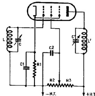
FIG. 71. — Montage d'une pentode  $R_1$  et  $C_1$ , polarisation ;  $R_2$ ,  $R_3$  et  $C_2$ , tension de la grille-écran.
