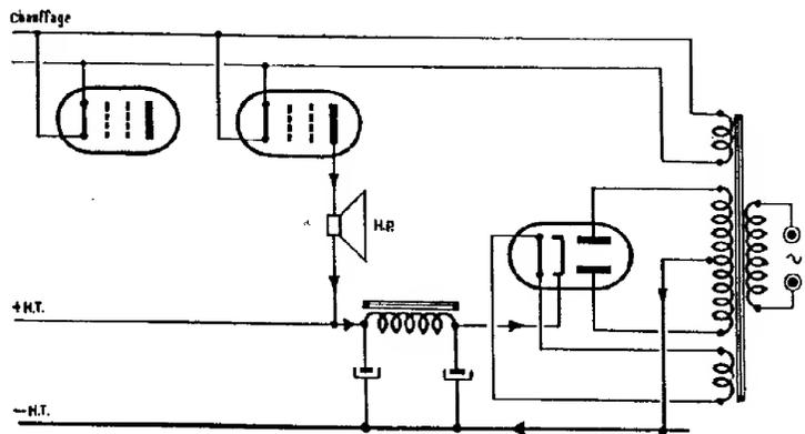
FIG. 90. — Alimentation complète d'un récepteur sur courant alternatif du secteur : chauffage, redressement HT par une valve biplaques à chauffage indirect et filtrage HT.
