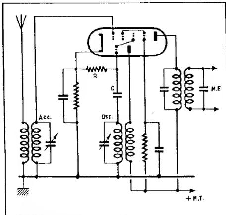
FIG. XV. — Changement de fréquence par triode-hexode.
