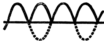
Fig. 84. Met getrokken lijnen: De vorm van den stroom, die verkregen wordt door gelijkrichting van beide halve perioden. Met stippe lijnen: De door de eene anode tegengehouden, maar door de andere gelijkgerichte halve periode.
