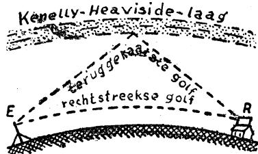
Fig. 102. De golf van den zender E komt langs twee verschillende wegen bij de ontvangantenne R aan: óf de oppervlakte van den aardbol volgend, óf na terugkaatsing in de hoogste lagen van onzen dampkring (in de Kenelly-Heaviside-laag).
