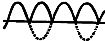
Fig. 84. Met getrokken lijnen: De vorm van den stroom, die verkregen wordt door gelijkrichting van beide halve perioden. Met stippellijnen: De door de eene anode tegengehouden, maar door de andere gelijkgerichte halve periode.
