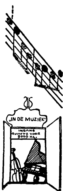
Fig. 109. Verdeeling van de frequenties van de zenders. De draaggolven zijn 9000 Hz van elkaar gescheiden. De modulatiezijband blijft binnen de 4500 Hz.
