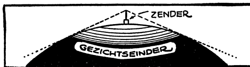
Fig. 1. De zekere rijkwijdte van een zender op metergolven wordt begrensd door zijn zichtbare horizon.
