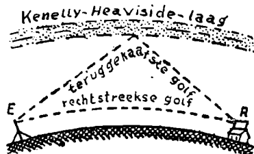
Fig. 103. De golf van de zender E komt langs twee verschillende wegen bij de ontvangantenne R aan: of de oppervlakte van de aardbol volgend, of na terugkaatsing in de hoogste lagen van onze dampkring (in de Kenelly-Heaviside-laag).
