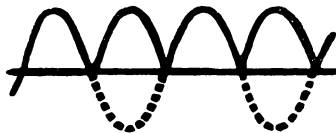
Fig. 86. Met getrokken lijnen: De vorm van de stroom, die verkregen wordt door gelijkrichting van beide halve perioden. Met stippellijnen: De door de ene anode tegengehouden, maar door de andere gelijkgerichte halve perioden.
