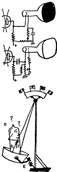
Fig. 7-1. Veel toegepast schema van een één-traps videoversterker. De PL83 kan ook worden vervangen door een EL41, EL84 enz. De omcirkelde spanningen zijn normale waarden, deze variëren enigszins met het soort toestel en het fabrikaat. 1)
