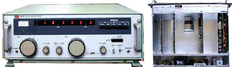
左：NRD-61A 後期バージョン、右：中央部は PTO、内部はガラ空き
