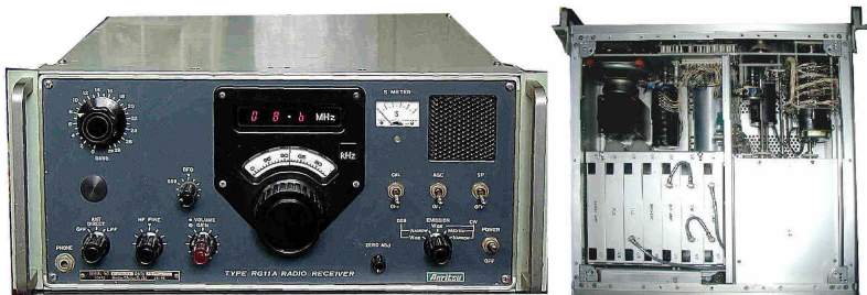
左:RG11A、右:上面(左:プリント基板、右:RF フロントエンド/シルド板の下、中央上部:PTO)
