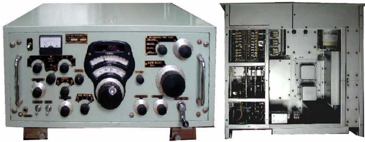
左 : 1st Lo、RF コイル (シールド板外し)、上中央 : VFO
