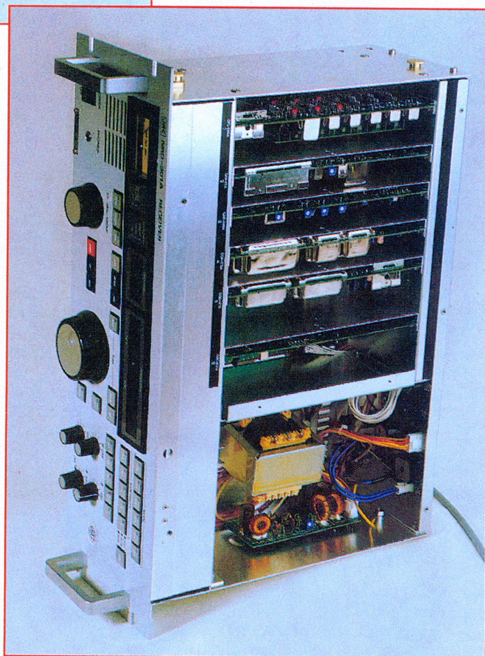
Japan Radio Company, wie wir sie kennen und lieben: der Aufbau erfolgte komplett auf voneinander abgeschirmten Platinen.
