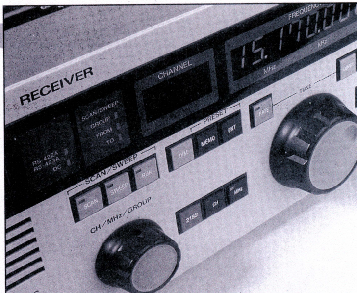
Um diese beiden Knöpfe dreht sich die Frequenzabstimmung: links in Schritten zu 1 MHz, recht in kleinsten zu einem Hertz.
