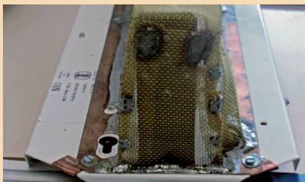
Fig. 5 Detailopname van bevestiging kopergaas
