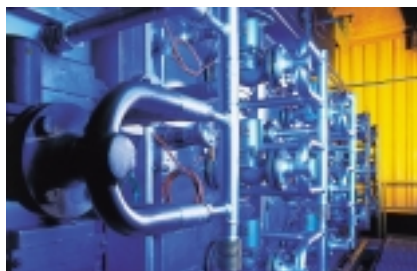
Haubenofen mit computergestützter Sinterführung
