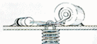
De veerspanning zorgt voor een betrouwbaar contact
