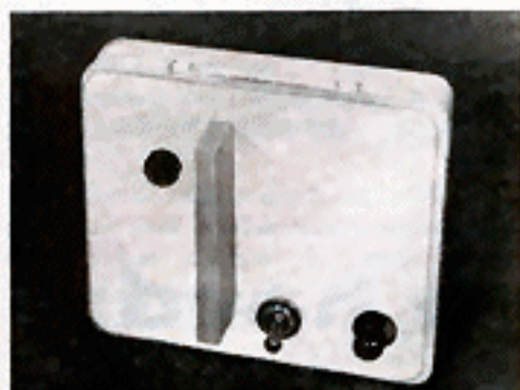
Trappenhuisverlichting: het verticale schot voorkomt terugwerking van lampje op L.D.R.
