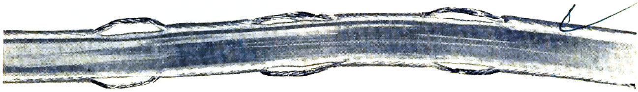
DE NATTIGHEIDSVOELER bestaat uit zogenaamd 300 ohm lintlijn. Op afstanden van \pm 2 cm zijn de draden over \pm 2 cm ontdaan van hun isolatie. Tussen de „nattigheidsvoeler” en de „natte luijer melder” zelf mogen wel enige tientallen meters draad komen.
