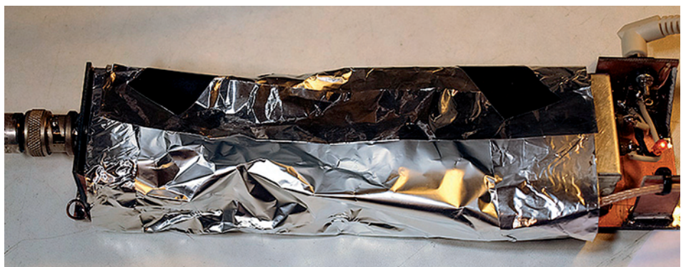
Foto 4 'Inside information' (afscherming tegen stoorsignalen van buiten)
